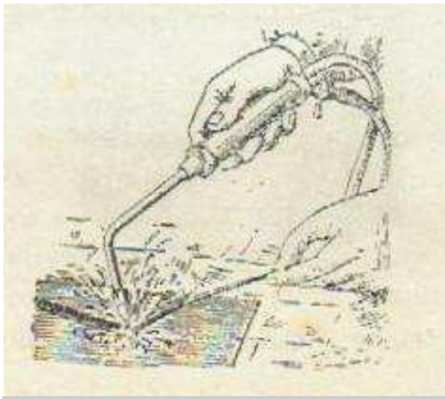
Operazione di saldatura al cannello con metallo d'apporto
